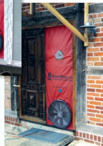
Mesurage BlowerDoor dans le cadre de la réhabilitation d'une maison à colombage
