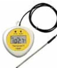
**Therma Data Logger - modèle TD1C**
