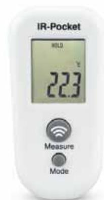
IR-Pocket thermometer possède 2 boutons. Le bouton mode permet à l'utilisateur d'accéder aux fonctions max/min, °C/°F blocage et émissivité. La fonction «blocage» permet de mesurer la température en continu et l'émissivité est ajustable selon le type de surface que vous avez à mesurer. La fonction extinction automatique au bout de 15 secondes permet de prolonger la durée de vie des piles.
