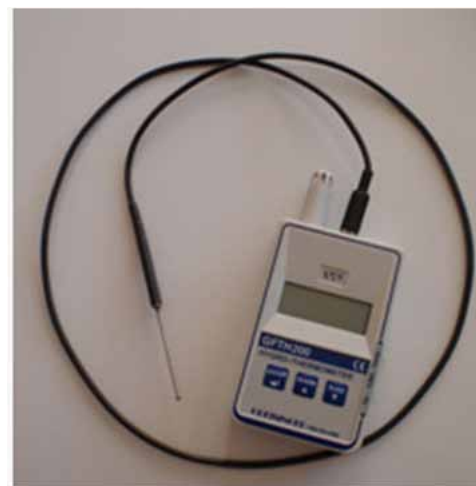
GFTH 200 avec la sonde externe de température Pt1000
