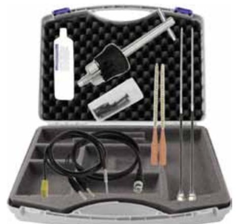
L'appareil GMH 3830 peut être utilisé avec d'autres sondes en option, par exemple, sonde de température et d'humidité pour le foin, copeaux de bois.
