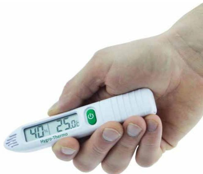
En pressant sur le bouton max/min, l'utilisateur peut voir les valeurs de température et d'humidité simultanément. Le boîtier est en plastic ABS et mesure 20 x 23 x 130 mm
