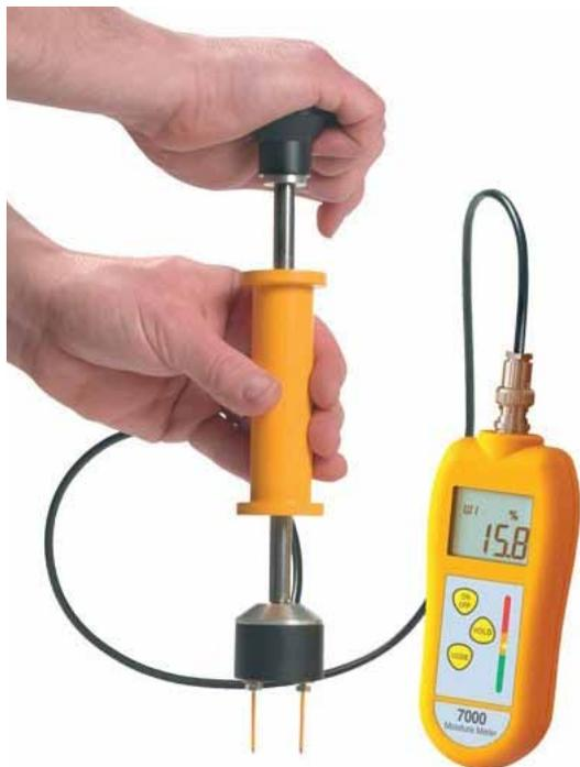
inclut Sonde d'humidité CH 180-160 pour usage général comprenant des sondes pointes livrée avec 7000 moisture meter
