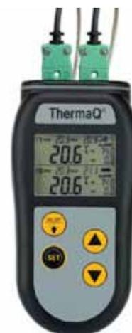
Ce nouveau thermomètre ThermaQ permet à l'utilisateur d'utiliser simultanément 2 sondes thermocouples Type K tout en affichant les 2 températures actuelles, ainsi que les températures maximales et minimales enregistrées. Ceci permet à l'utilisateur de surveiller, par exemple, à la fois la température du four et en même temps la température d'un produit. Cette
